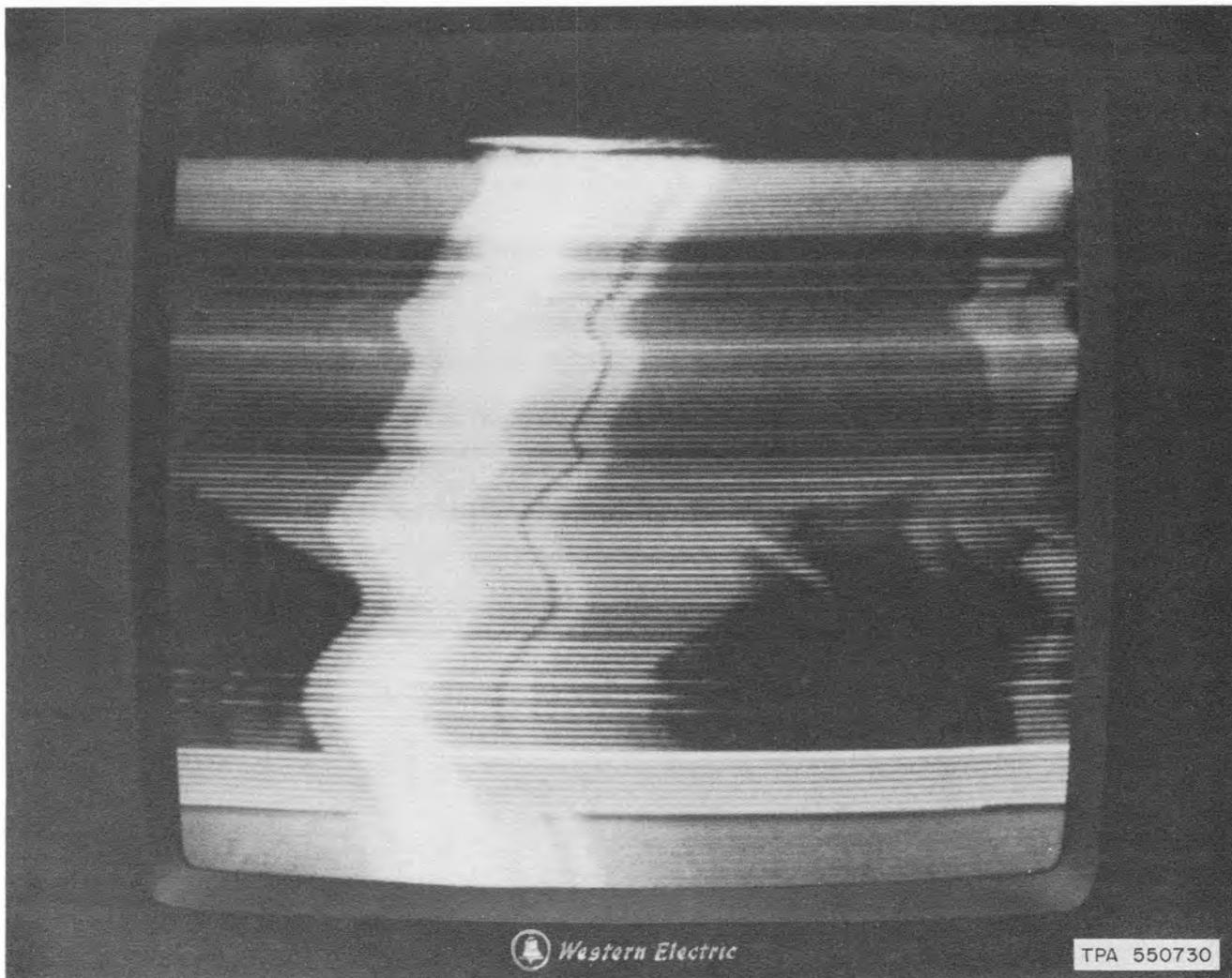
◆ Fig. 7—Tip-Ring Reversal Image on Display Unit ◆
