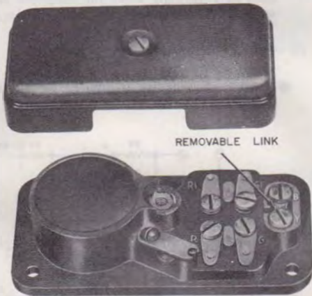
Fig. 3—1542A Inductor and Schematic
