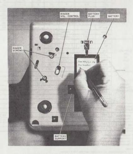
Fig. 6-2872A1M or 2872A2M Telephone Set, Bottom View
