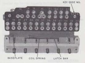
Fig. 13—589-Type Key, Top View
