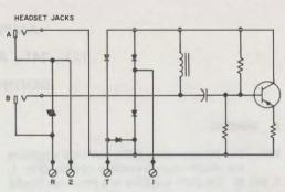
Fig. 4—242B Amplifier Schematic
