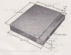
Fig. 1—113A Apparatus Box, MD
